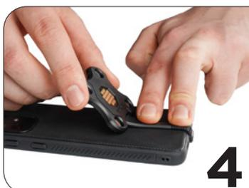
Appuyez à la base du Magnetic POGO Pin Dongle pour placer et tendre le câble
