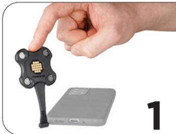
Nettoyez et séchez la surface avant l'installation du Magnetic POGO Pin Dongle
